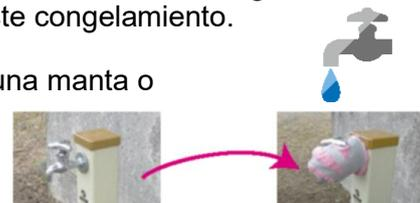
**Precaución : Si vierte agua hirviendo directamente, puede agrietar el tubo o el grifo.**
